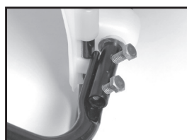
Figura 3 Deslice los pernos a través de los orificios
